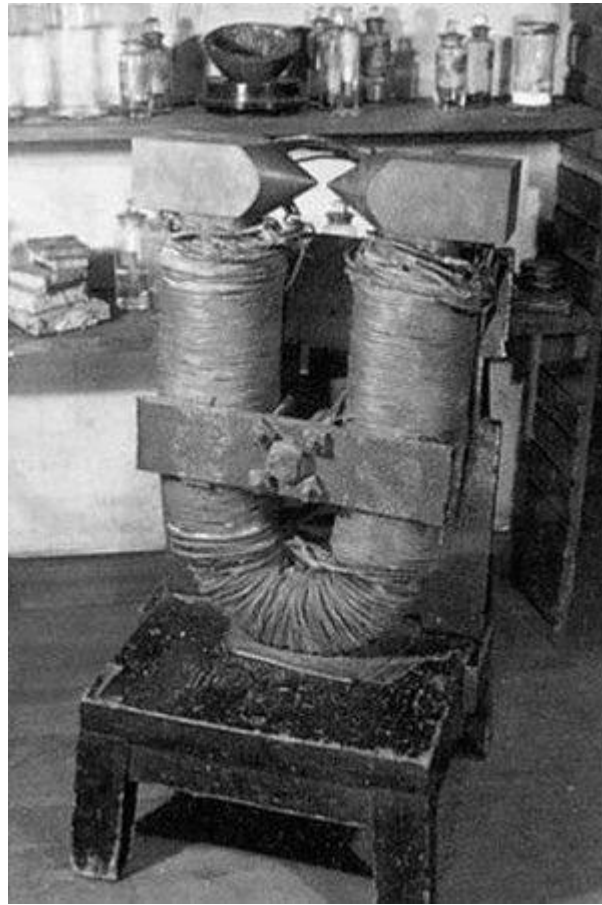
Electroimán de herradura utilizado por Faraday.
